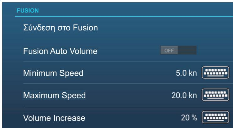
**[Σύνδεση στο Fusion]:** Πραγματοποιείται σύνδεση στον εξοπλισμό σας FUSION.
