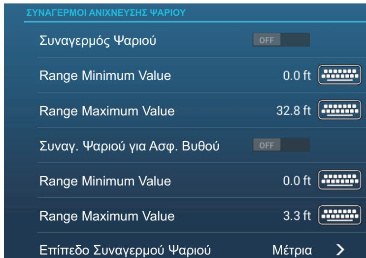
3. Ρυθμίστε το αρχικό βάθος στο στοιχείο μενού [Range Minimum Value] και το τελικό βάθος στο στοιχείο μενού [Range Maximum Value].
