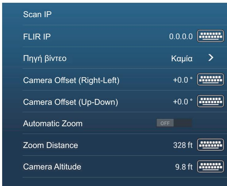
**Σημείωση:** Για να χρησιμοποιήσετε τη λειτουργία PTZ της κάμερας FLIR με τη μονάδα NavNet TZtouch2, απαιτείται μια ρύθμιση (Διασύνδεση Nexus CGI, Θύρα: 8090) στην κάμερα FLIR. Ανατρέξτε στις οδηγίες χρήστη της κάμερας FLIR για λεπτομέρειες.
