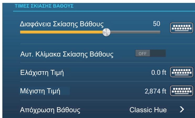
**[Αυτ. Κλίμακα Σκίασης Βάθους]:** Ενεργοποίηση ή απενεργοποίηση της επιλογής αυτόματης κλίμακας σκίασης βάθους.
